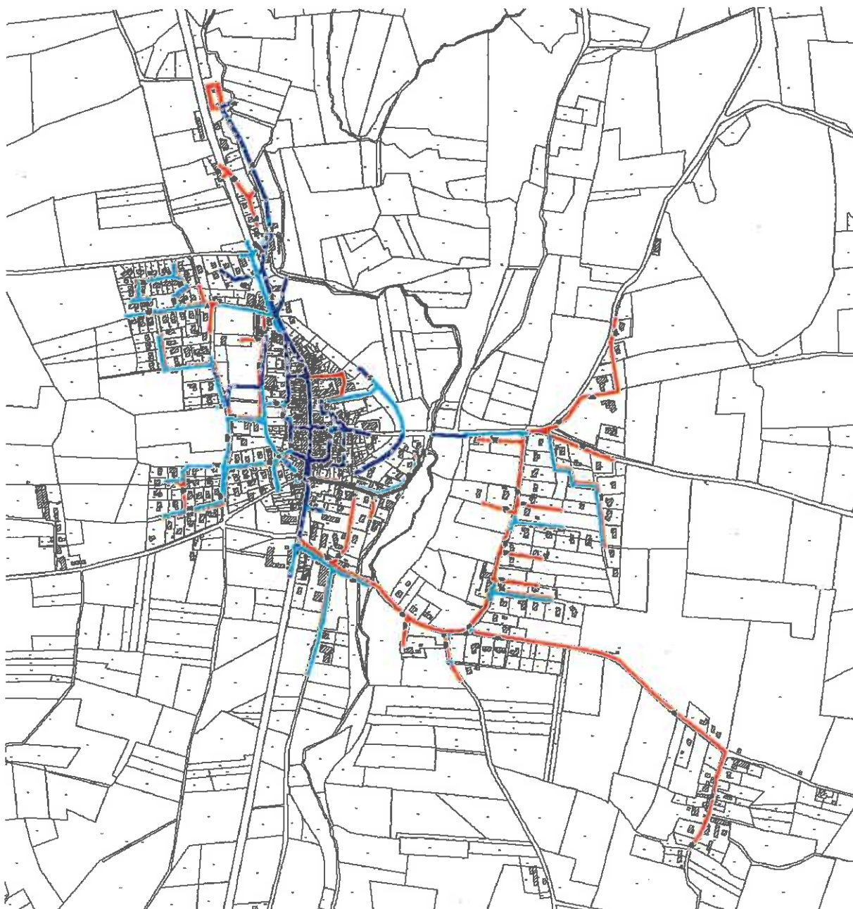
Plan des réseaux d'assainissement du centre
