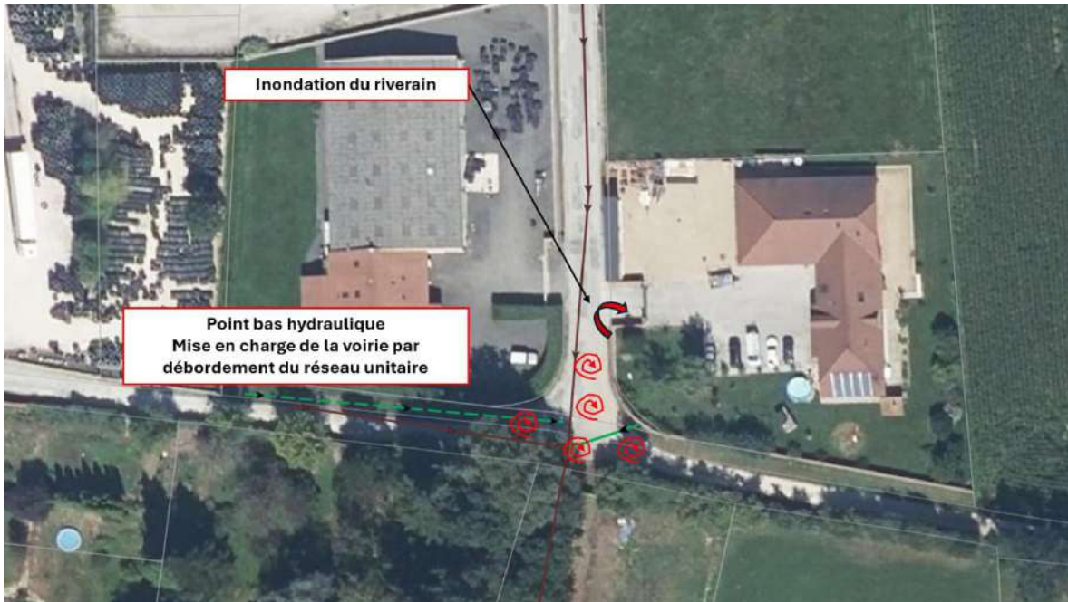
Figure 20 : Description problème hydraulique 2
