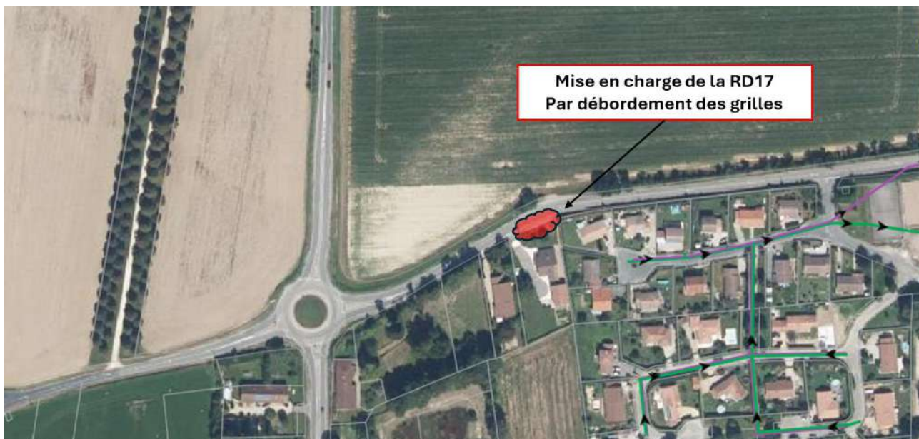
Figure 22 : Description problème hydraulique 3
