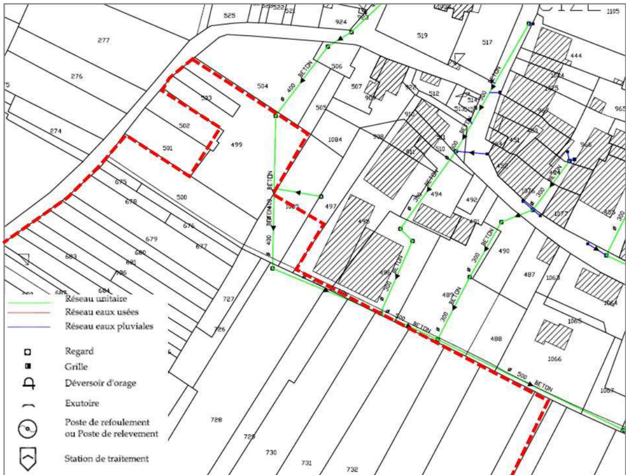
Extrait du plan des réseaux d'assainissement annexé au PLU en vigueur (périmètre partiel du projet de maraîchage en tirets rouges)
