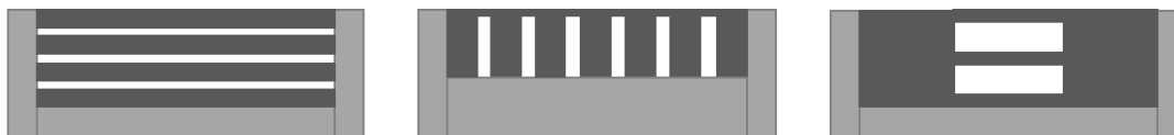
Schémas illustratifs : clôtures avec muret de 0,5 à 1 m, avec panneau présentant un dispositif ajouré de 30% de vide sur leur emprise
