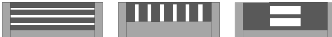
Schémas illustratifs : clôtures avec muret de 0,5 à 1 m, avec panneau présentant un dispositif ajouré de 30% de vide sur leur emprise
