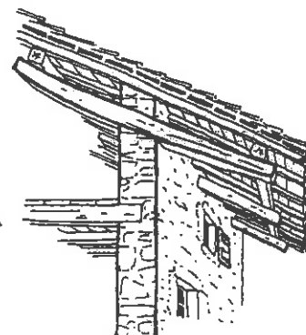
Débord à poutres à bascule
