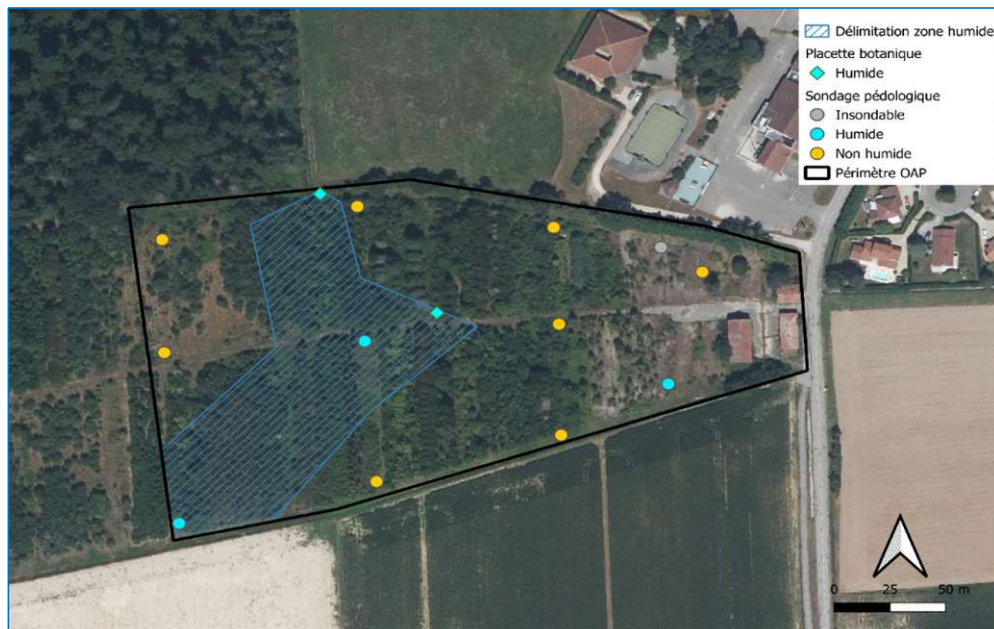
Résultat des sondages pédologiques réalisés sur la zone, Géonomie 2022
