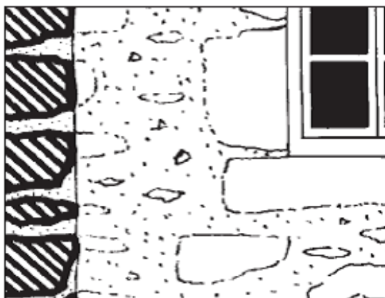
Joints à pierre vue
