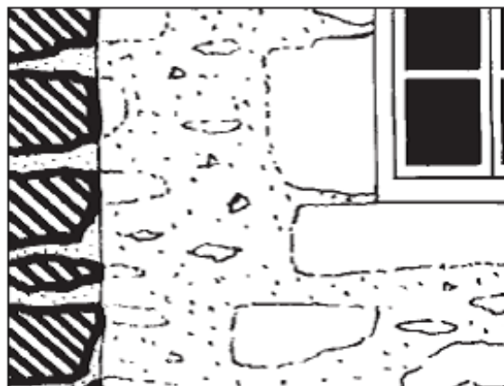
Joints à pierre vue
